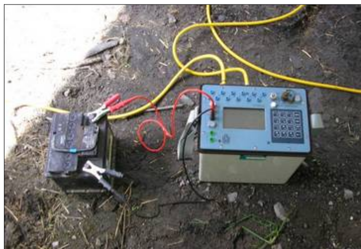
Fig. 9 – Georesistivimetro SYSCAL Pro Switch 72 con alimentazione esterna (comune batteria da auto da 12V).
