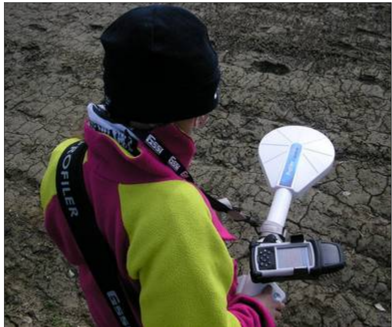
Fig. 4 – Acquisizione dipolo verticale (dettaglio bobina trasmittente).
