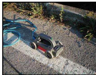
Antenna radar per rilievi strutturali (frequenza = 1.5 GHz)
