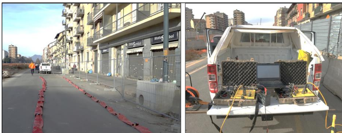
Sistema di acquisizione dati sismici in continuo (prototipo Techgea)
